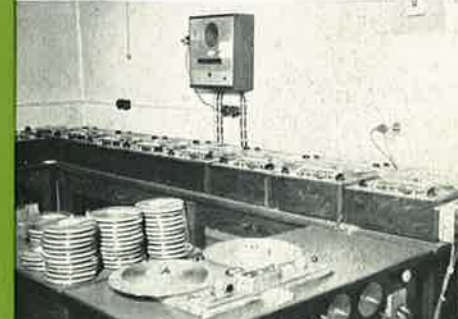
↓ Blindenhörbücherei Marburg, Bandkopieranlage, ausgerüstet mit Laufwerken Typ 120 in Spezialausführung und MTG 9 als Abspielmaschine
