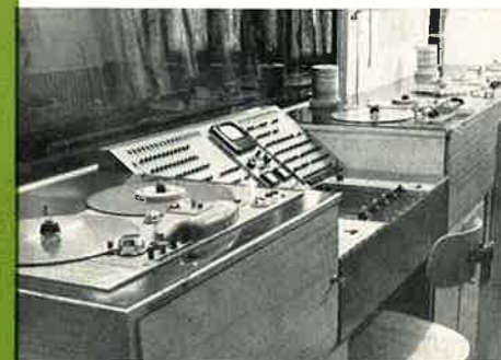
Bischöfliches Filmwerk Rottenburg, Studio zur Filmvertonung VOLLMER 007, VOLLMER Mischverstärker, mit Verteiler, 3 VOLLMER MTG 9, davon 2 Stück seit 10 Jahren im Betrieb
